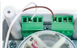
Фото 15. Подключение датчика к электроприводу
