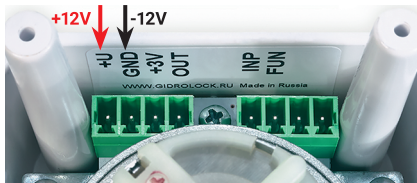
Фото 20. Клеммы разъема электропривода для подключения внешнего блока питания +12 В, проводного выключателя, объединения в систему нескольких шаровых электроприводов
